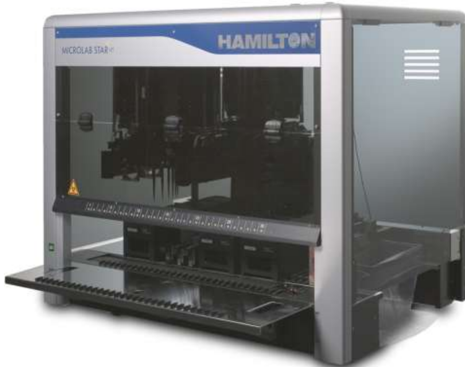
全自動分注ロボット(前処理用) HAMILTON社製MICROLAB
