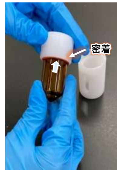
③ O-リングが 上蓋に密着するまで 押し込みます。
