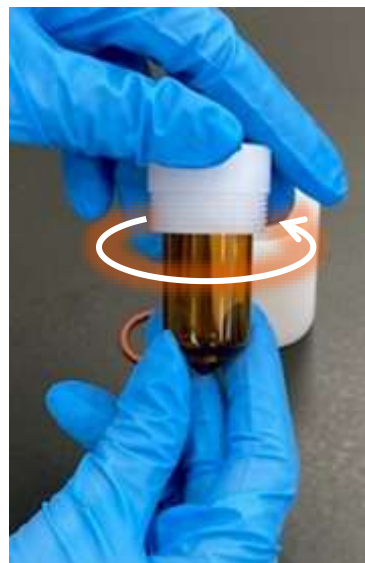
① バイアルを 上蓋 にねじ込みます。
