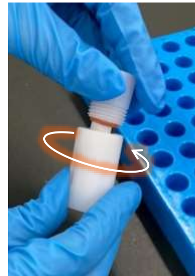
③ 下蓋をねじ込み 、O-リングを挟み込むようにシールします。
