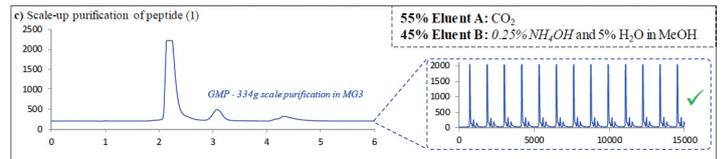
Column : DCpak® P4VP, 30mm×250mm, 5μm
