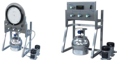
容量比混合を用いて標準ガスを調整するための圧力ゲージユニットです。キャニスターに手動圧希釈装置を取り付けるだけで、希釈ガスを調整することができます。
