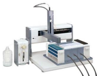
G-Prep FAは固相ミニカラムを効率的に運用し、再現性、信頼性のある食品分析の試料前処理に特化した自動前処理システムです。正確な作業が要求されるミニカラム操作を自動化できます。
